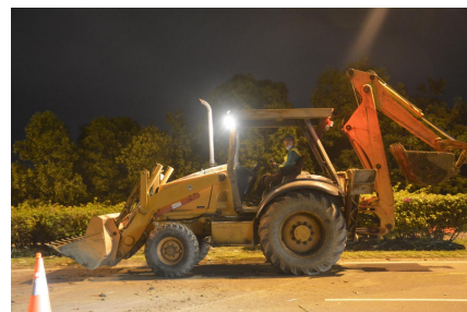
Gambar 2: Sekiranya melaksanakan kerja pada waktu malam, pastikan jentera dilengkapi dengan cahaya lampu.
